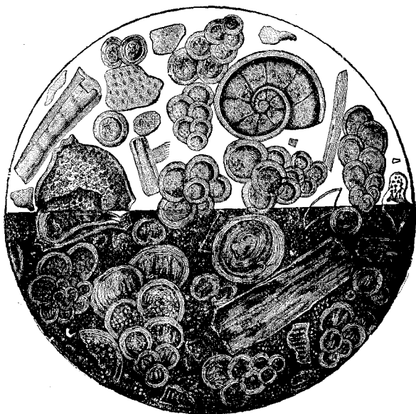
Fig. 57. — Fragmento de giz visto com o microscopio (uma metade foi ligeiramente atacada por um acido).
