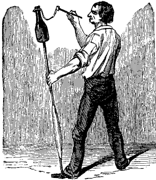
Fig. 71. — Terminação do gargalo de uma garrafa.
